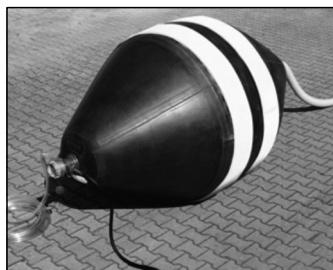
Balón obturador para pruebas de presión Balón Ciego + Balón con by pass de 150 a 400mm. Manguera de inflado, Válvula de seguridad y manómetro. Presión de inflado de balón: 1 bar.
